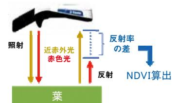
図3 GreenSeekerの測定原理
